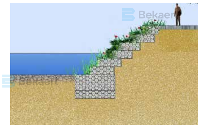
阶梯结构挡墙可在造价与占地面积间找到平衡点
