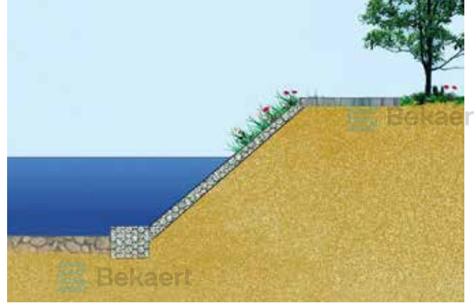
网垫护坡可有效防治水力侵蚀
